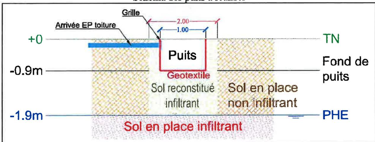
Ces puits seront destinés à ne recevoir que les eaux pluviales issues des toitures qui ne présentent donc pas de charge en polluant. Tout rejet dans le puit d'autre type d'effluent sera formellement interdit et ce afin de préserver la qualité de la nappe phréatique sous-jacente. Le stockage préalable des eaux de toiture pour une utilisation est autorisé, mais cette eau ne pourra plus après utilisation être rejetée dans le puit.
