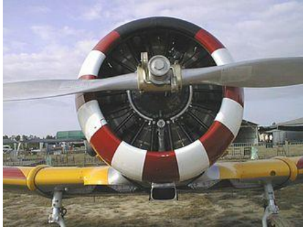
Moteur Pratt & Whitney R-1340 Wasp d'un T-6G Texan.
