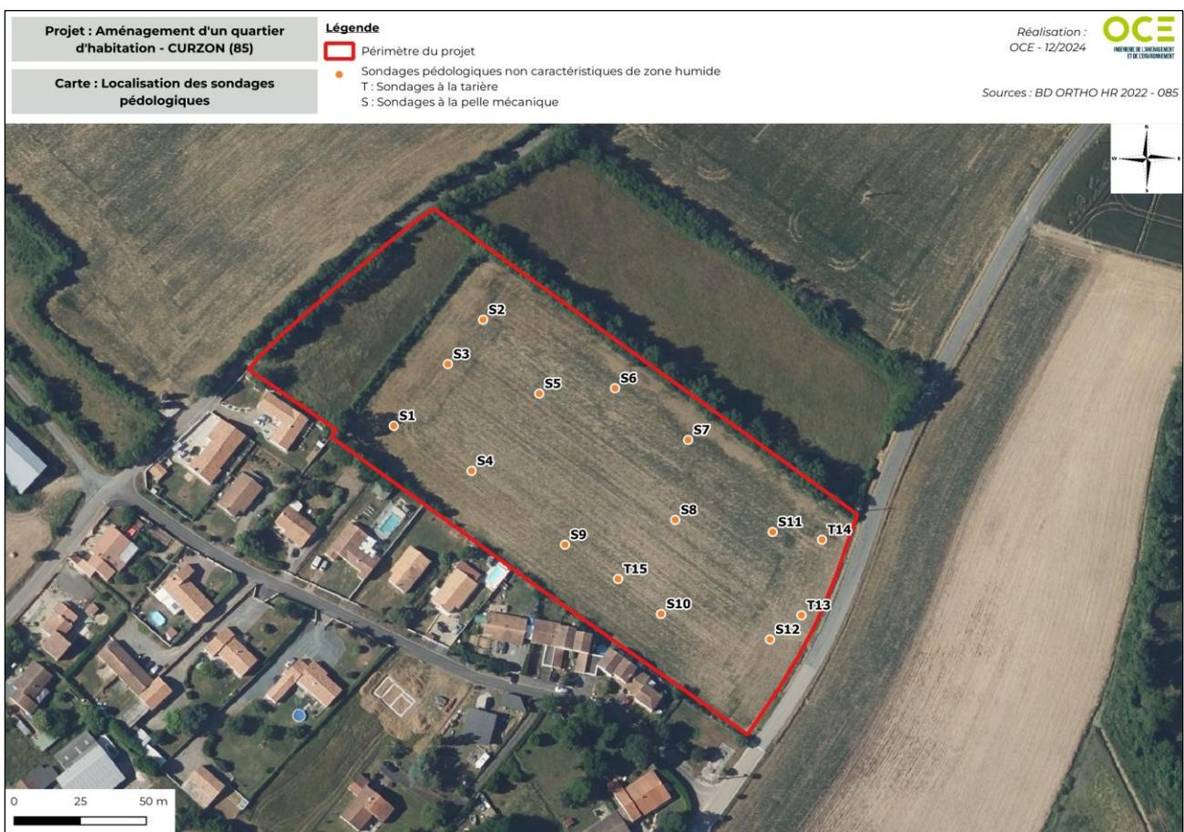
Figure 25 - Localisation des sondages pédologiques réalisés
