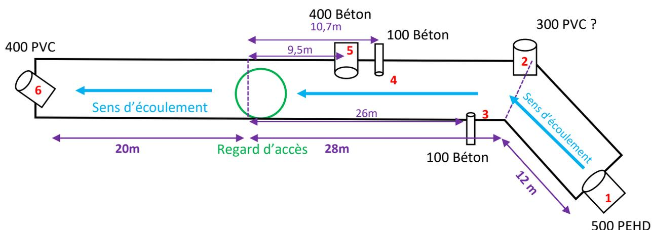
A priori, la galerie ne collecte pas d'eaux usées : aucune trace, aucune odeur, aucun bruit d'écoulement, et enfin aucun écho lorsque que les tampons fonte du réseau EU à proximité ont été tapés.
