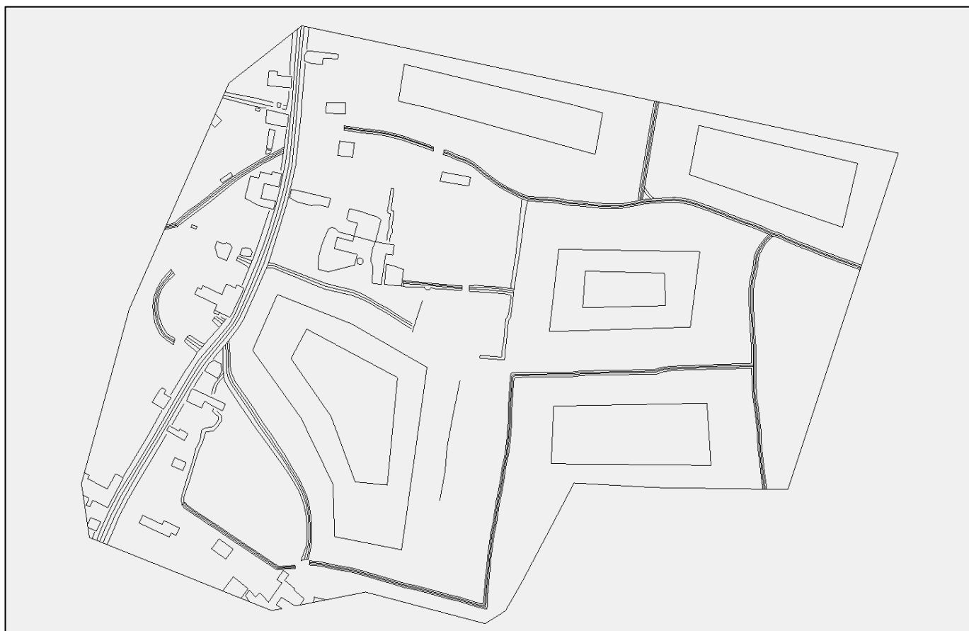
Illustration 13 : Définition des lignes structurantes du modèle hydraulique 2D
