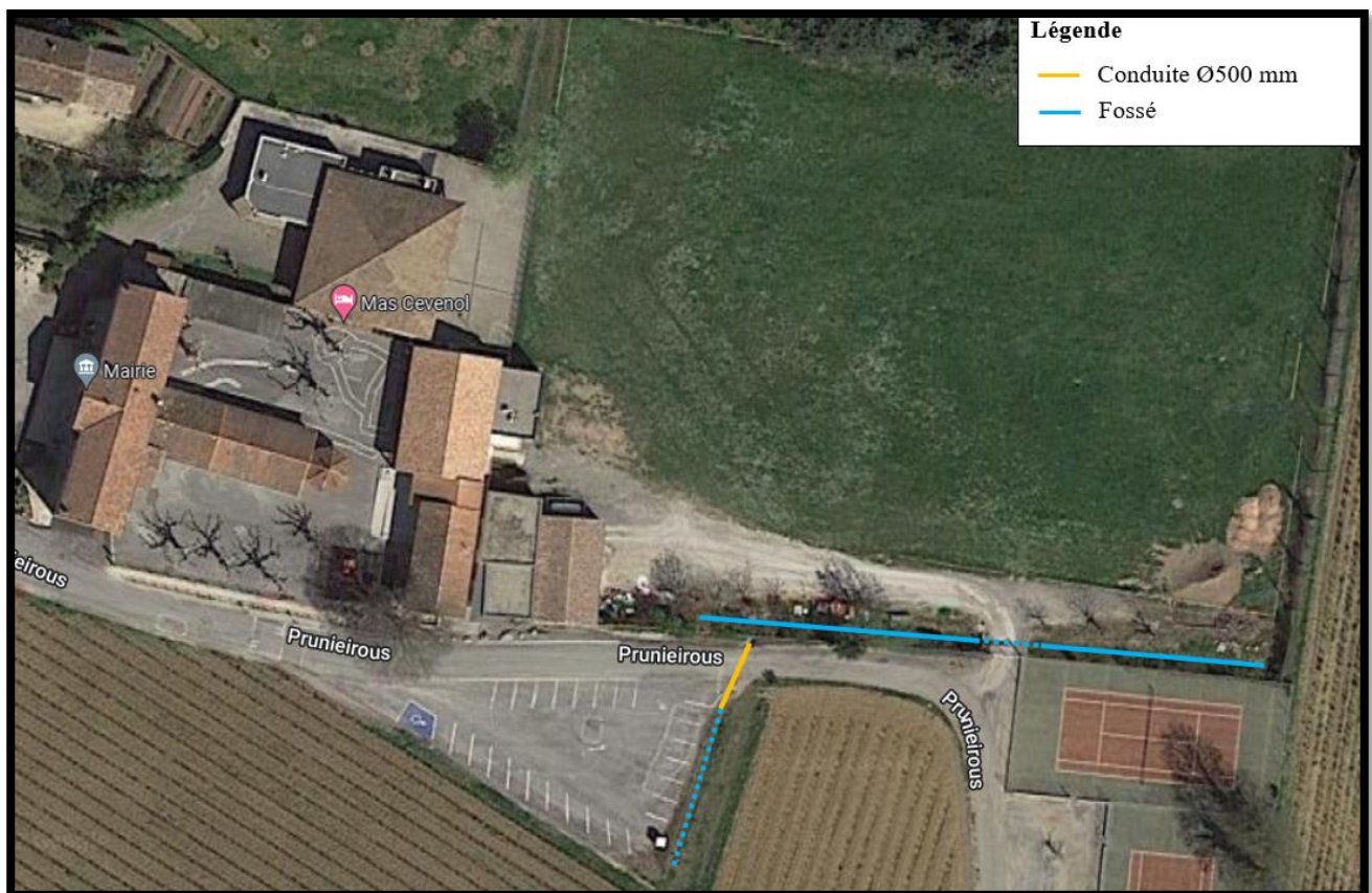
Figure 10 : Localisation de la conduite Ø500 mm
