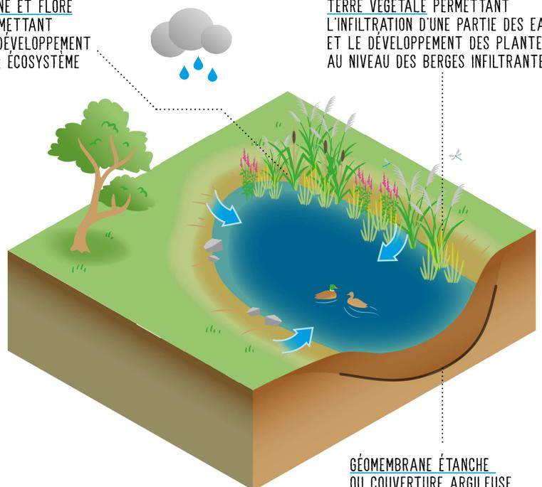
GÉOMEMBRANE ÉTANCHE OU COUVERTURE ARGILEUSE SUR UNE PARTIE DU FOND DE L'OUVRAGE POUR LA GARDER EN EAU
