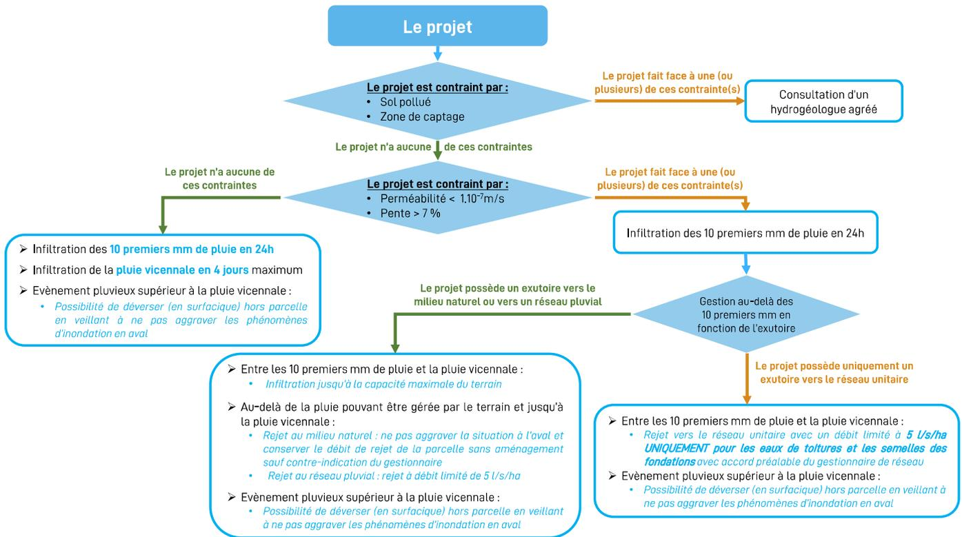
En cas d'impossibilité technique avérée, le propriétaire pourra, au cas par cas et avec l'accord de l'entité compétente, effectuer un rejet de ses eaux pluviales vers le milieu naturel ou un réseau à un débit limité de 5 l/s/ha via un dispositif adapté.
