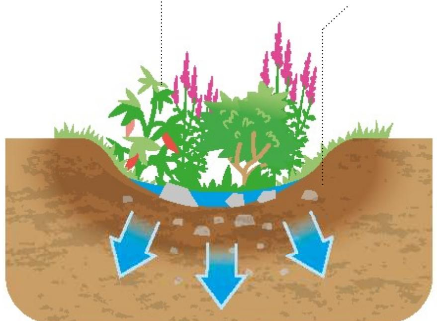
Pour définir la perméabilité du sol et dimensionner l'ouvrage, réaliser un essai de type Matsuo.
