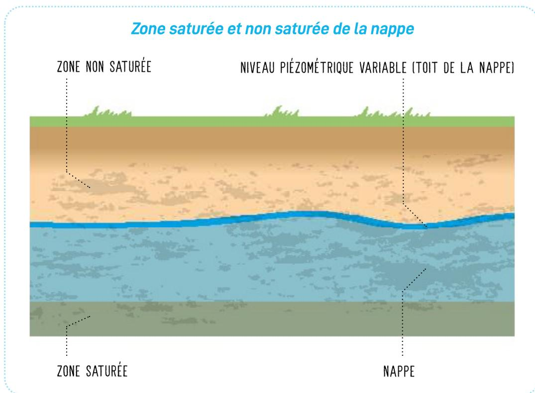
**Dans le cadre de l'infiltration des eaux pluviales, le fond des ouvrages ne doit pas atteindre la zone saturée.** En effet, ces remontées de nappes viennent saturer les sols en eau réduisant la capacité d'infiltration et la capacité épuratoire des sols.
