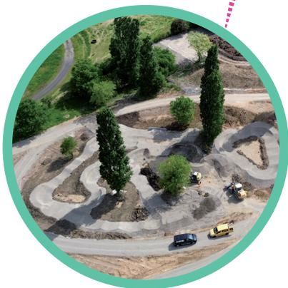
Le **pump-track** est un circuit en boucle avec des bosses et des virages relevés, fait pour les sports de glisse : trottinette, vélo, roller, BMX ou skate. 3 circuits seront proposés (95 m, 75 m et 50 m), adaptés aux différents niveaux de pratique. Un espace spécialement aménagé pour le skateboard sera également accessible.
