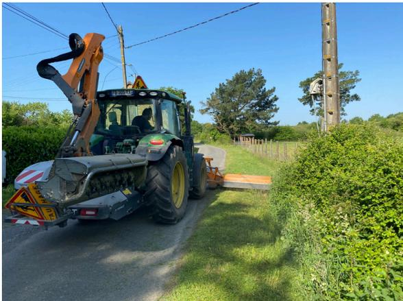
Un dégagement de visibilité est réalisé dans un premier temps dans les sections potentiellement dangereuses (intersections, virages dangereux, voies communales à forte circulation...).
