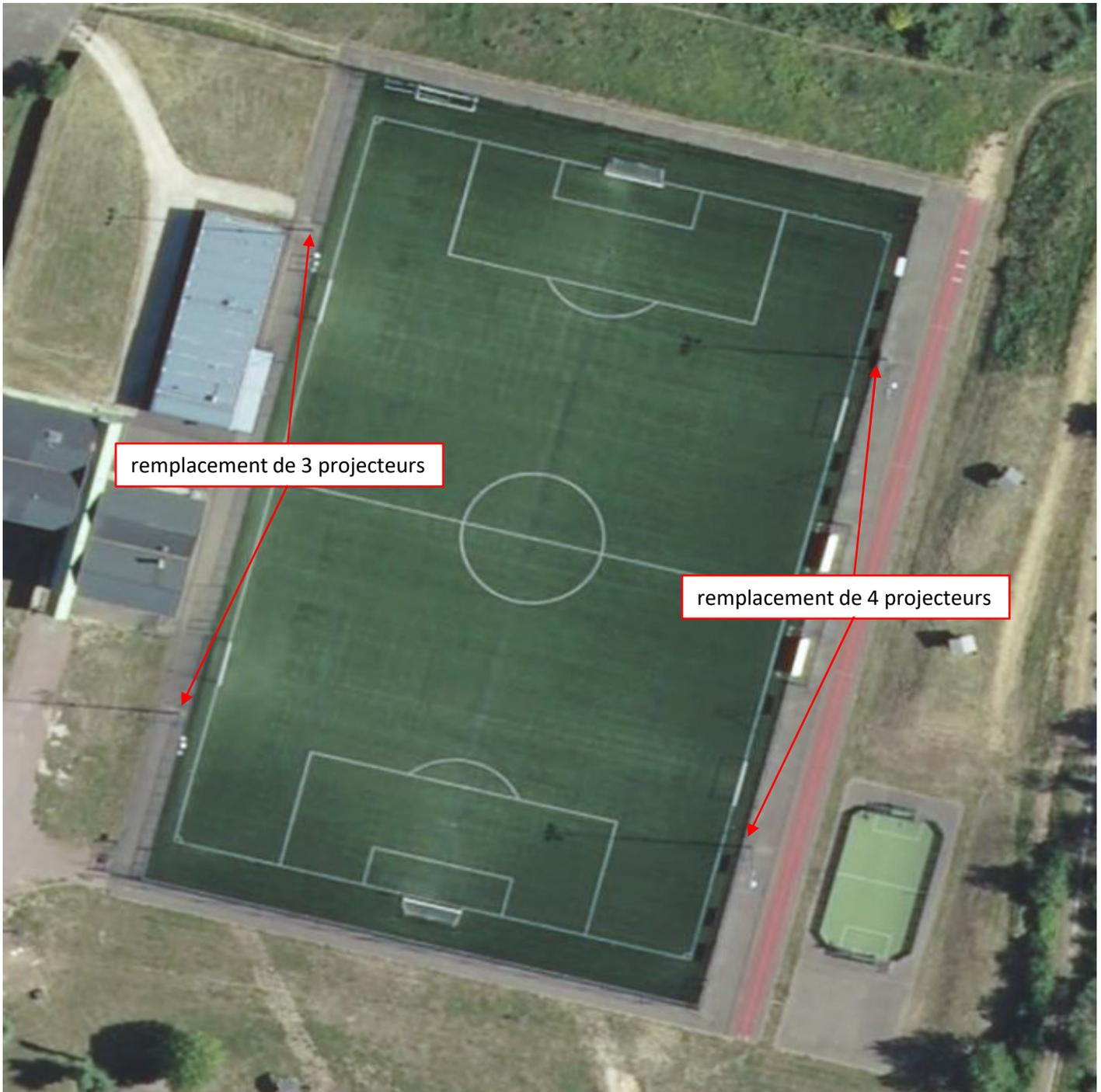
Pour la réalisation de ces travaux, une étude de stabilité doit être effectuée pour vérifier si les projecteurs LED peuvent être installés sur les mâts existants.
