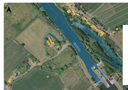
Le **projet de turbine hydroélectrique sur la Deule**, au niveau de l'écluse, a fait l'objet de plusieurs rencontres avec différents partenaires. Ce projet reste soumis à l'arbitrage des VNF - Voies Navigables de France. Avec une puissance de 210 Kwc liée à la chute d'eau permanente et une production potentielle de 1040 Mwh/an, l'intérêt de ce projet n'est pas à démontrer.
