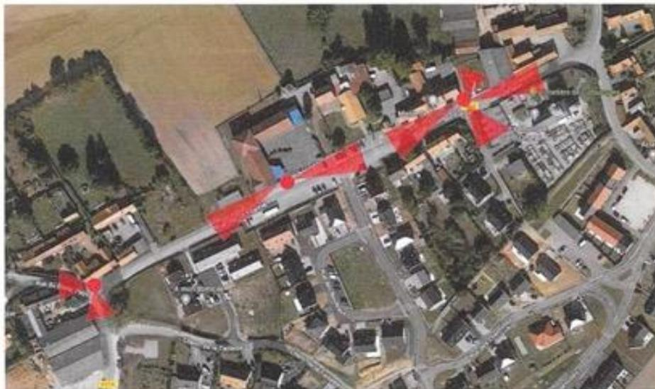
Au total 3 caméras sur ce site. C2 caméra 4 têtes positionnée face à la mairie, C3 caméra 2 têtes positionnée face à l'école et C4 caméra 2 têtes positionnée à l'intersection de la rue de la mairie et du blanc pays.
