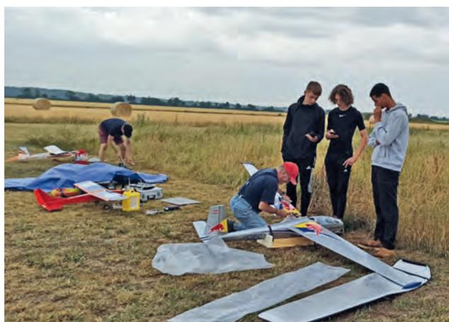
Concernant les aigles, le but a été de réaliser, à partir d'une feuille blanche, et au moyen d'imprimante 3D, d'imprimante laser et de découpe laser, toutes les pièces des aigles, principalement en bois, complétées d'un moteur thermique, des éléments de contrôle et guidage ainsi que leur design, différent pour chacun, avant de les assembler.
