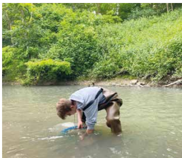
Prélèvement au filet Surber pour un IBGN au gué Perriau à Villedômer.
