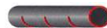
CANALISATIONS RIGIDES Ø100mm AVEC OUVERTURES Ø 10mm OU FENTES DE 5mm minimum ESPACÉES TOUTS LES 10 À 15cm
