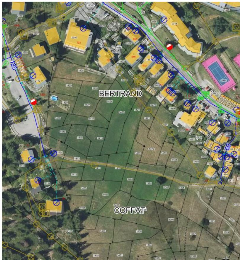
*Figure 8 : plan des réseaux dans la zone d'étude, en jaune les eaux usées*
