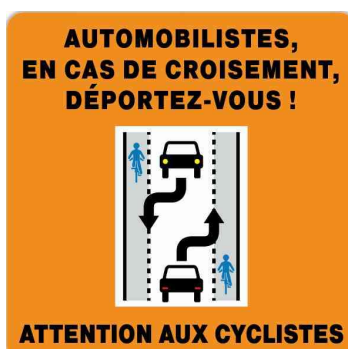
Schéma de principe de fonctionnement d'une CVCB
