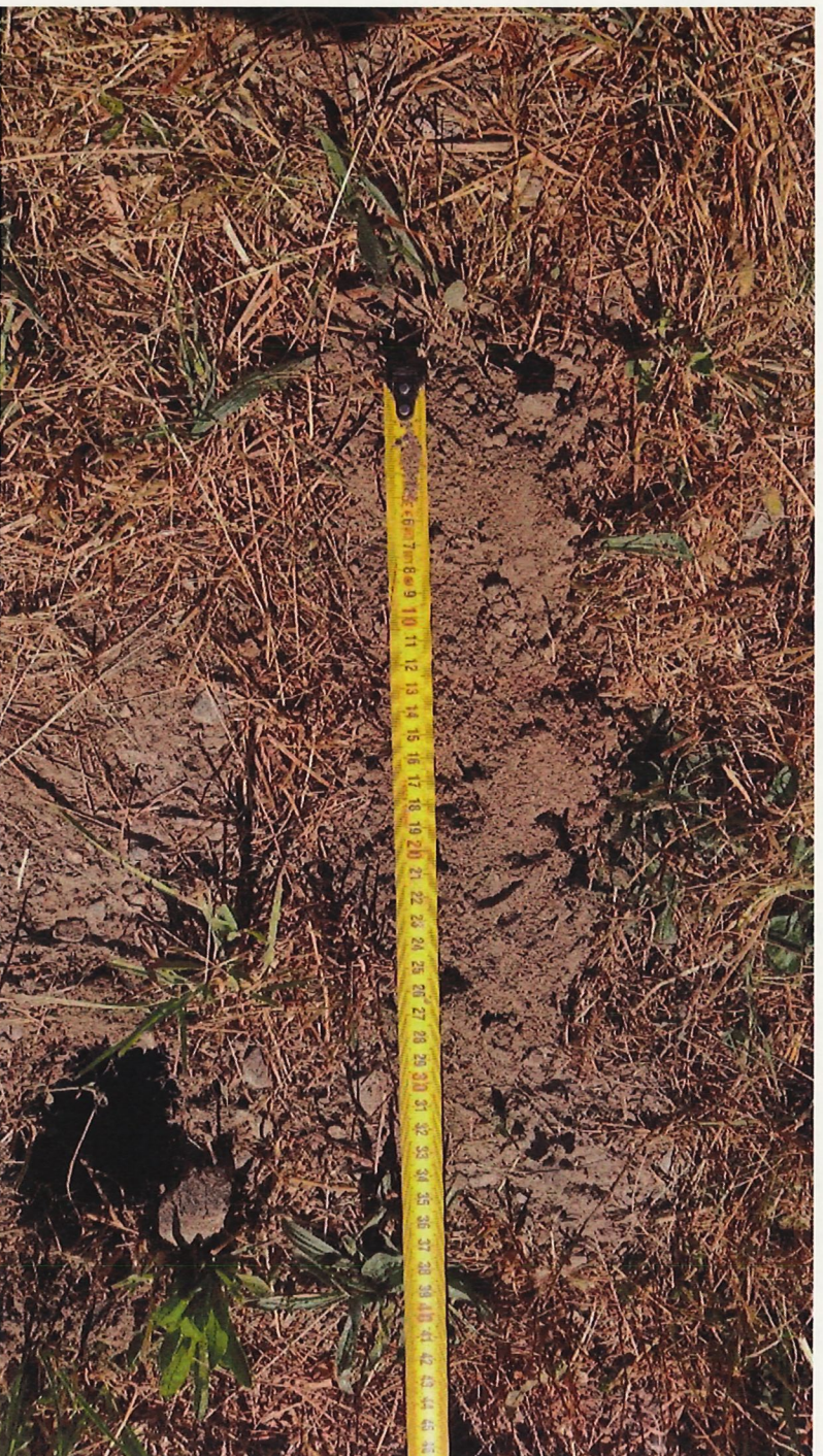
Exemple de carottage : Sondage n°10 : milieu de la parcelle, sol sec (Epode, 28 juillet 2022) Absence de traces d'hydromorphie
