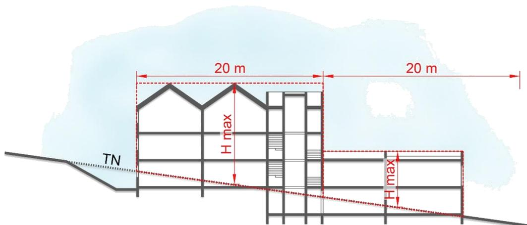
La hauteur s'apprécie par rapport au niveau du terrain existant avant travaux, à la date de dépôt de la demande. Les schémas ci-après illustrent la règle :
