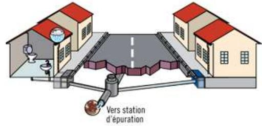
Ce système est le plus ancien et il équipe la plupart des centres villes historiques. Il présente l'inconvénient de diluer et de surcharger le réseau avec risque de déversement au milieu naturel d'une partie de la charge polluante par temps de pluie. Les à-coups hydrauliques liés aux flux d'eaux pluviales compliquent la bonne gestion de la station d'épuration.
