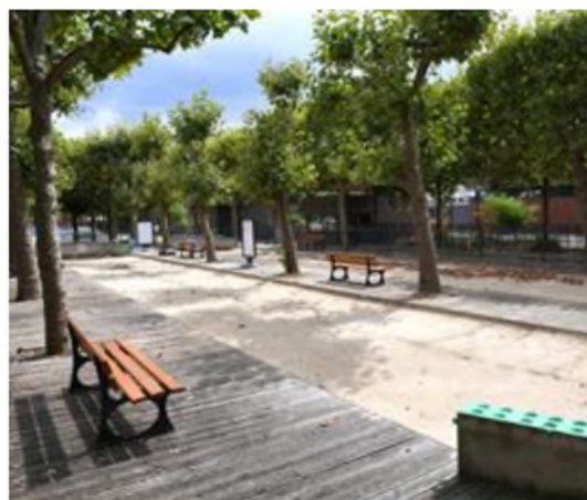
REVÊTEMENT PERMÉABLE EN SABLE ET BOIS.
