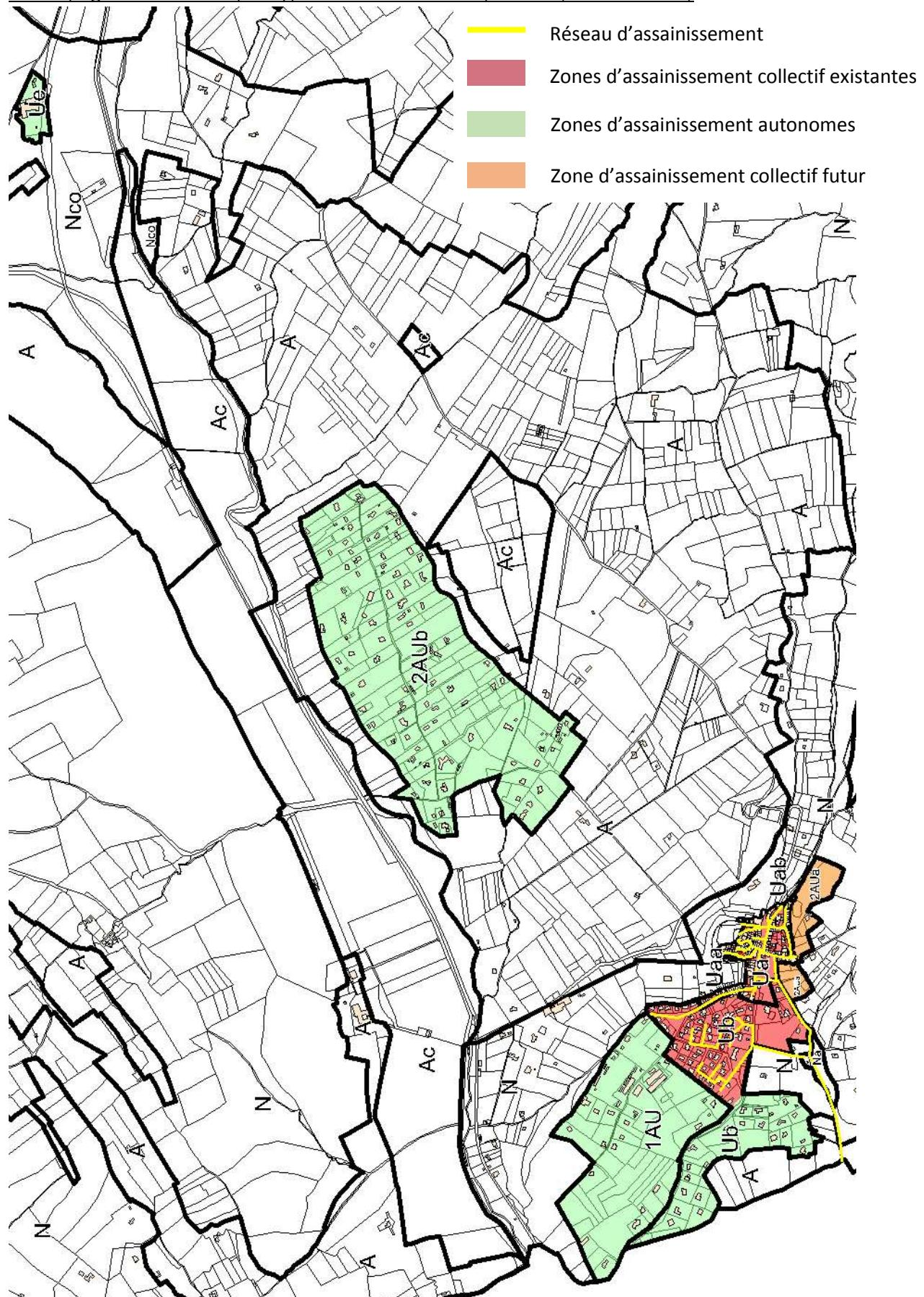
Superposition du zonage du PLU avec la carte réalisée dans le cadre du schéma directeur d'assainissement
