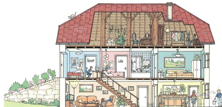
Illustration des transformations apportées à une ferme traditionnelle où l'habitation colonise l'ensemble du volume autrefois dédié aux besoins agricoles (source : CAUE39).
