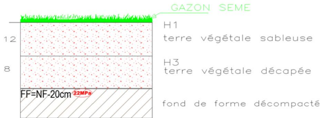
Figure 7 Principales caractéristiques de la structure
