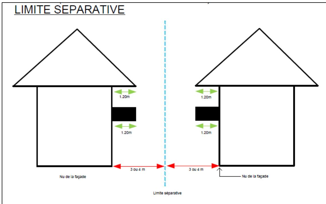
La distance comptée horizontalement de tout point d'une construction ou installation au point de la limite parcellaire de la propriété voisine qui en est le plus rapproché doit être au moins égale à 3 m.
