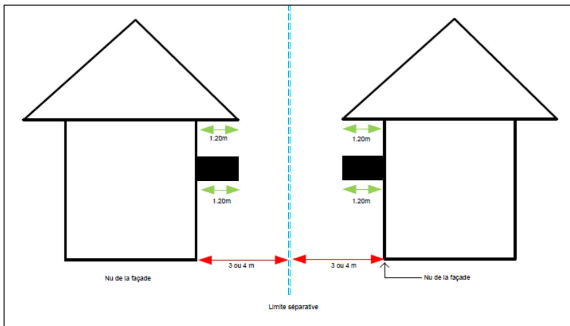
La distance comptée horizontalement de tout point d'une construction ou installation au point de la limite parcellaire de la propriété voisine qui en est le plus rapproché doit être au moins égale à :
