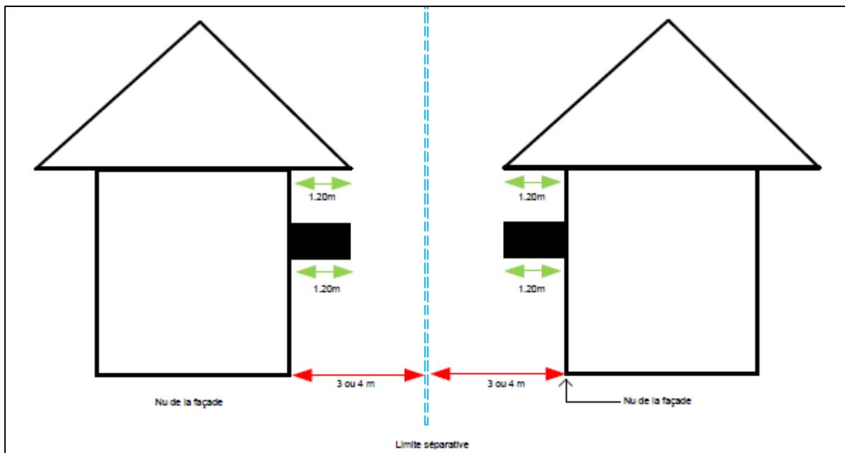
La distance comptée horizontalement de tout point d'une construction ou installation au point de la limite parcellaire de la propriété voisine qui en est le plus rapproché doit être au moins égale à 3 m.
