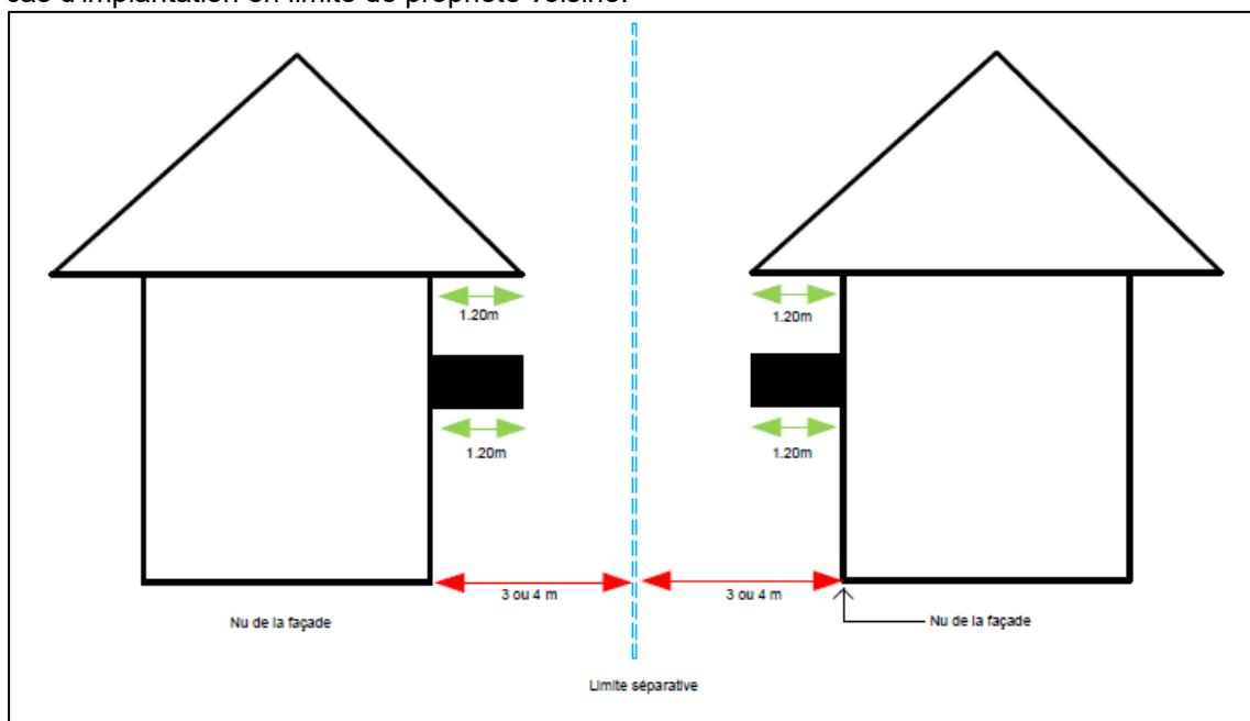
La distance comptée horizontalement de tout point d'une construction ou installation au point de la limite parcellaire de la propriété voisine qui en est le plus rapproché doit être au moins égale à 3 m.
