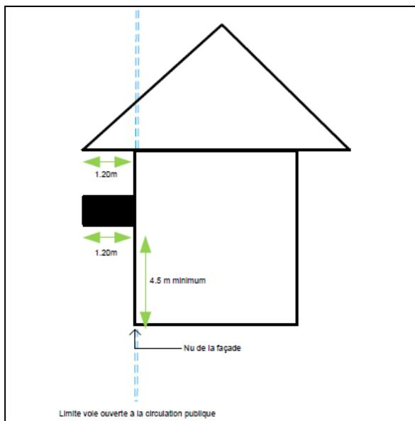
Sous réserves de retraits particuliers, s'ils existent, fixés par les marges de recullement indiquées au règlement graphique du PLU (pièce n°3-1), les constructions et installations doivent respecter, par rapport aux emprises publiques et aux voies existantes, à modifier ou à créer, un recul minimum de 3 m.
