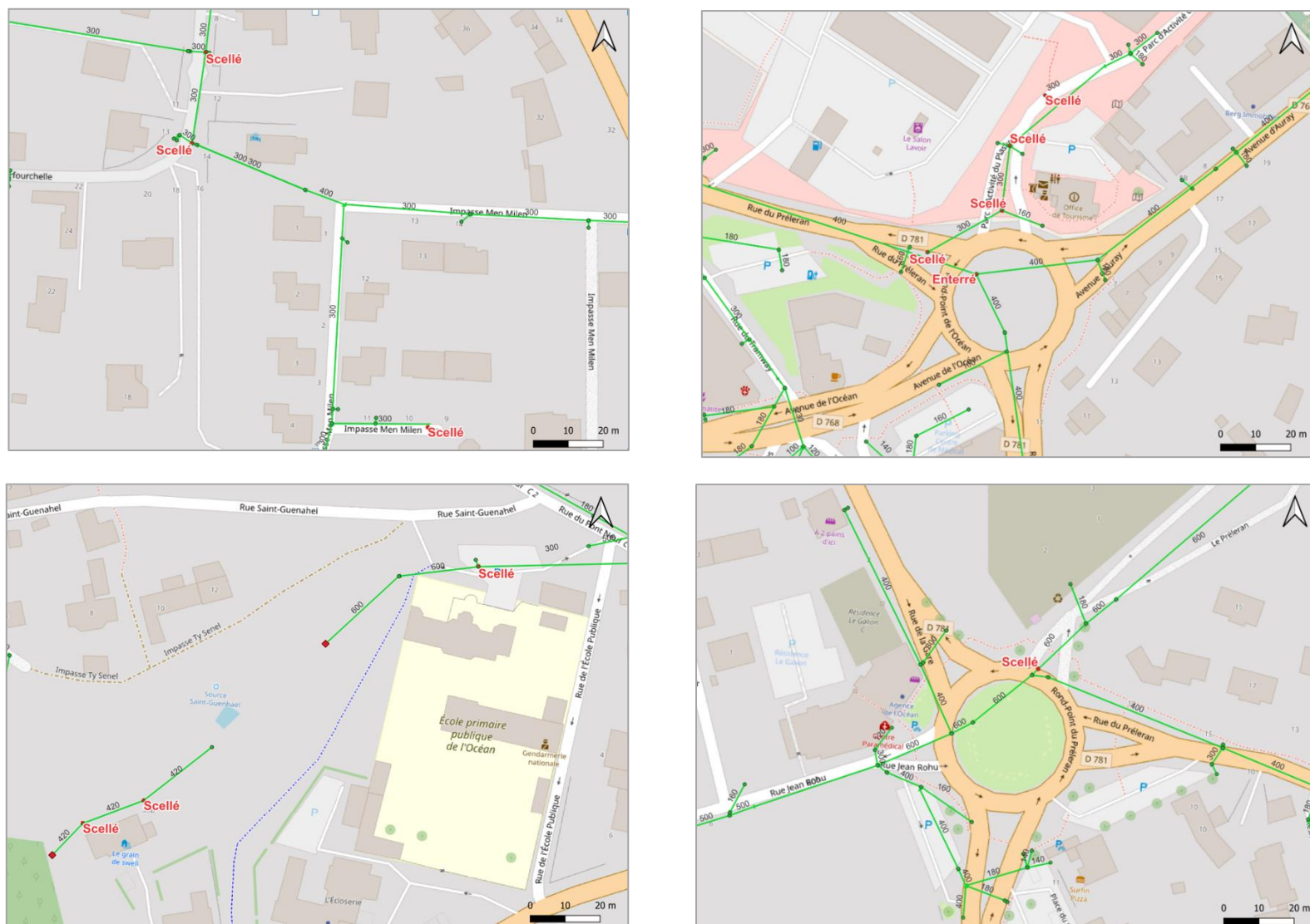
Figure 26 : Emplacement des regards scellés sur le réseau de collecte des eaux pluviales
