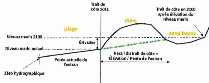
Schéma de principe de la méthode « Estran » avec connexion de zone basse
