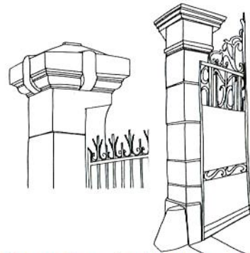
Piles en pierre de taille, chasse-roue et ferronnerie
