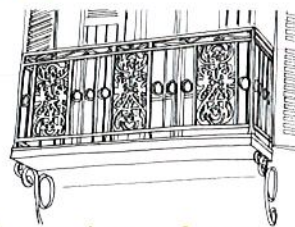
Balcon et corbeaux en ferronnerie
