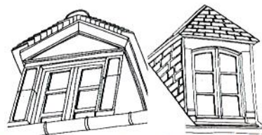
Lucarnes maçonnées en pierre, en bâtière pour la première et capucine pour la seconde
