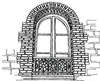
Ouverture avec encadrement en brique, linteau cintré, appui de fenêtre en pierre et garde-corps en ferronnerie
