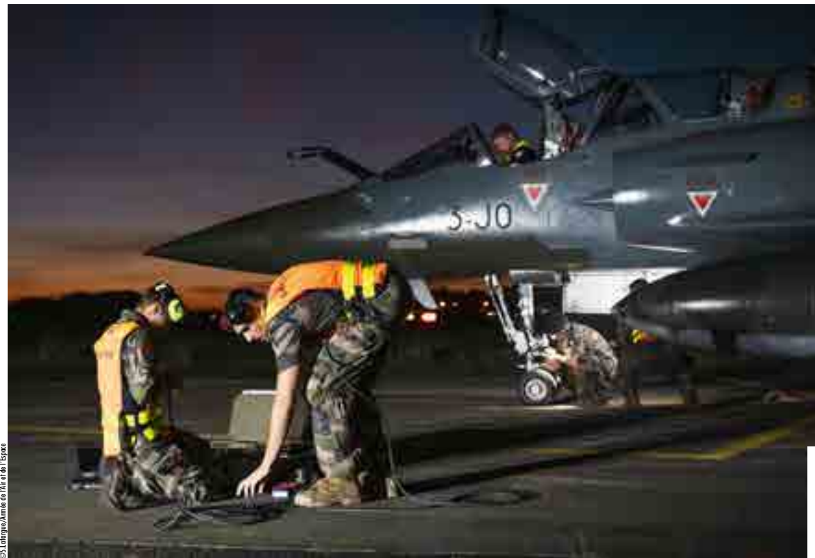
Des techniciens de maintenance effectuent des points fixes dans le cadre d'une opération de vérification.
