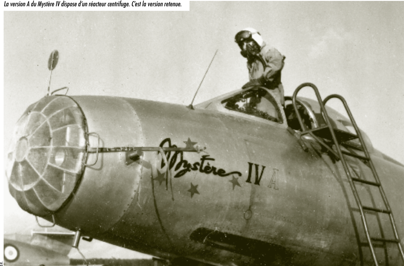
La version A du Mystère IV dispose d'un réacteur centrifuge. C'est la version retenue.
