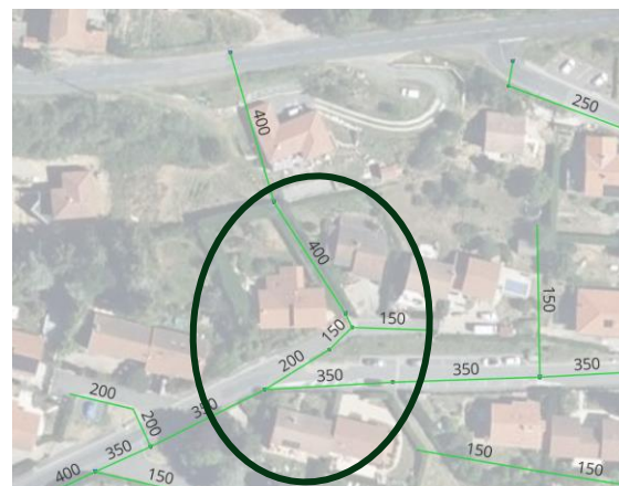
Variations de diamètres sur le réseau d'eaux pluviales
