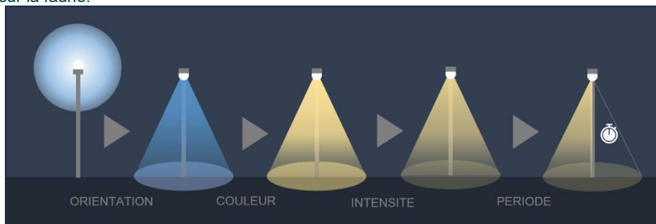
Schéma de principe de limitation de la pollution lumineuse par l'éclairage (Biotope)
