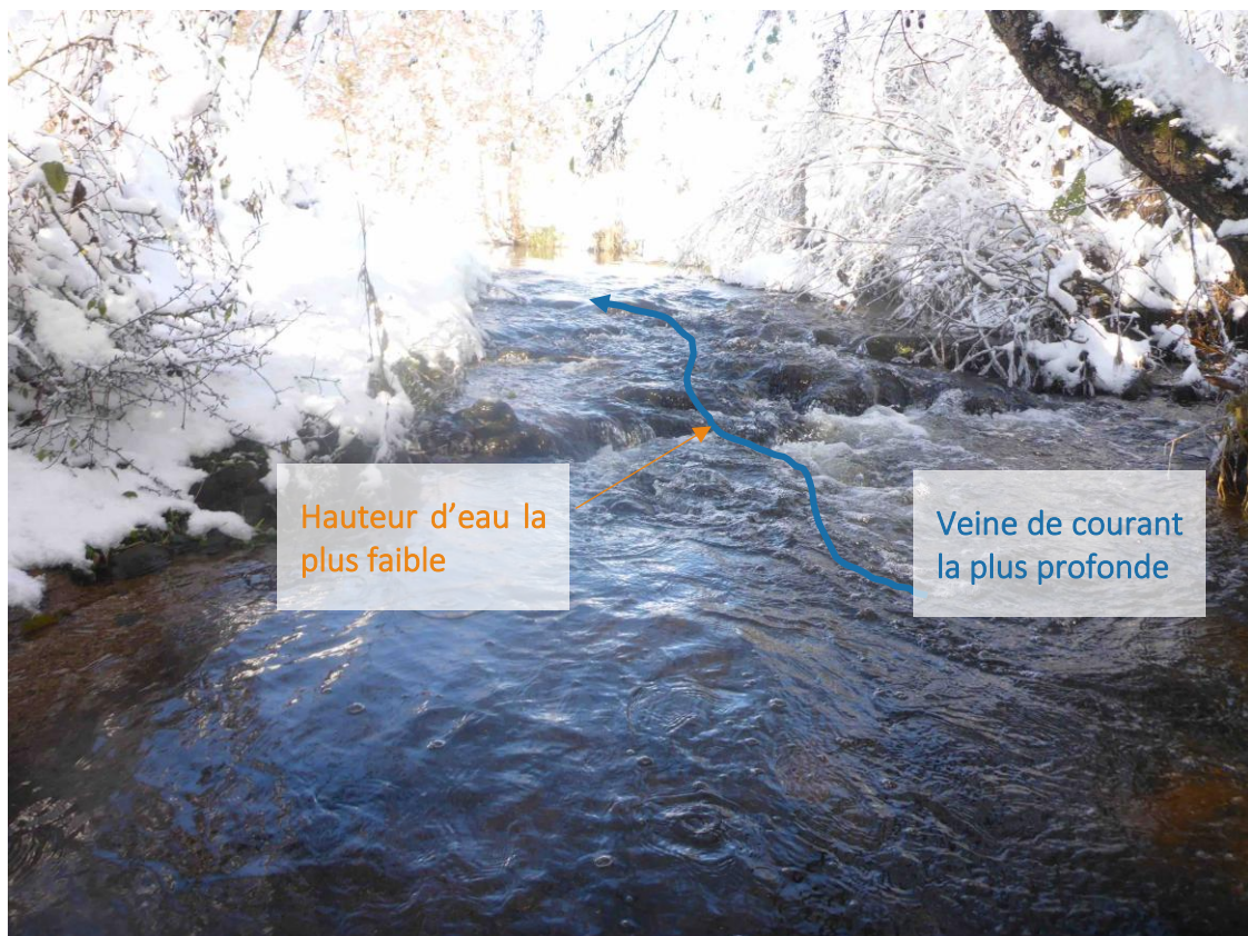
Radier photographié à deux débits différents et principe de mesure des hauteurs d'eau de la veine la plus profonde.
