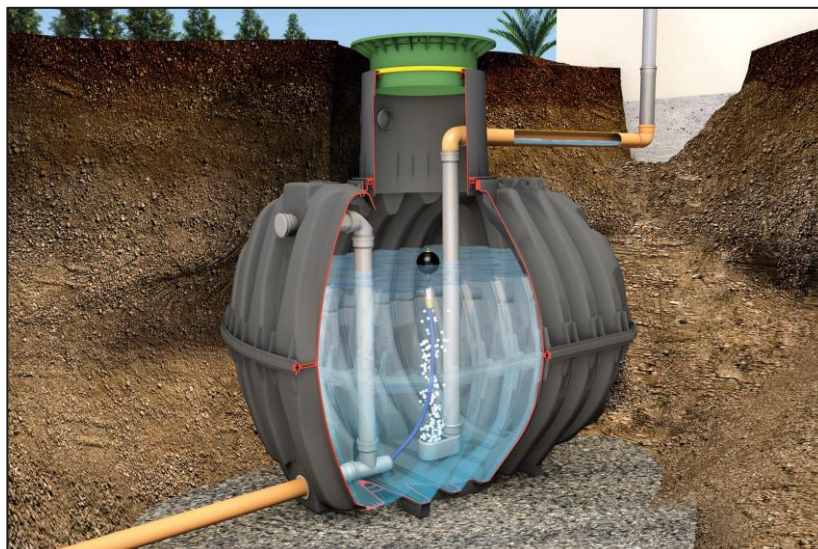
Figure VI-2 : exemple d'ouvrage de rétention des eaux pluviales
