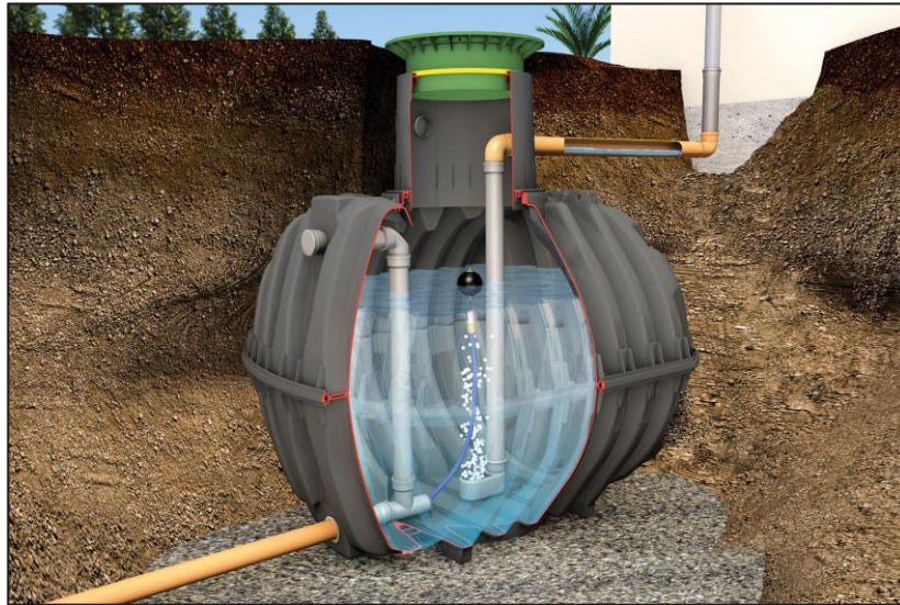
Figure II-2 : exemple d'ouvrage de rétention des eaux pluviales
