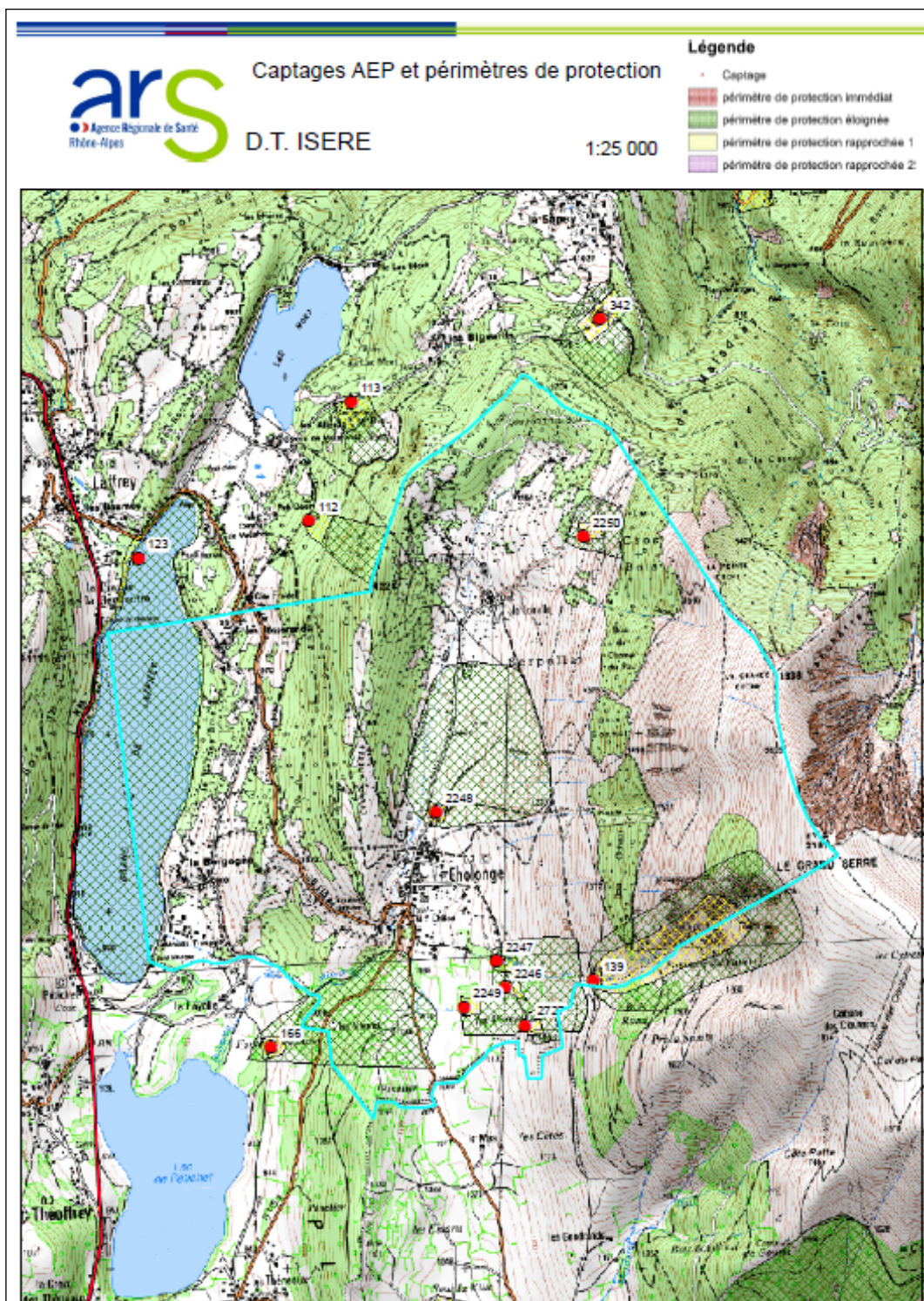
Périmètres de protection des captages AEP de Cholonge proposés par l'hydrogéologue agréé, ARS, 2011
