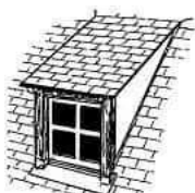
lucarne rampante ou en chien couché
