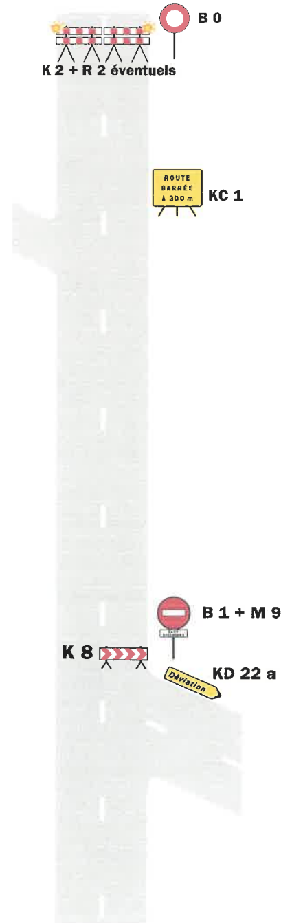
Coupure de la route quelques centaines de mètres après l'entrée de l'itinéraire de déviation
