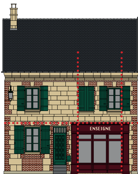
Bâti traditionnel en pierre avec harpage* en brique : choisir une devanture en applique
