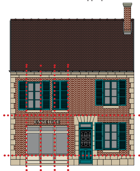
Bâti traditionnel en brique avec harpage * en pierre : choisir une devanture en feuillure
