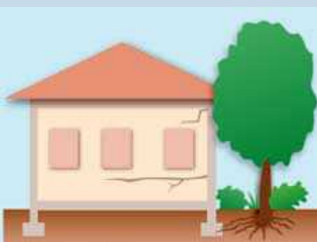
Désordres partiels dûs à l'action localisée d'un arbre
