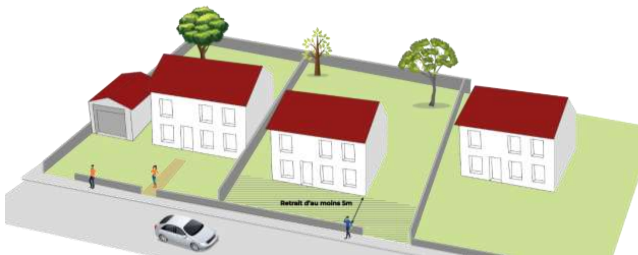
Schémas d'implantations autorisées pour les constructions en zones Uc et Uh par rapport aux limites d'emprises publiques – Implantation en retrait d'au moins 5m – schéma illustratif, sans valeur réglementaire
