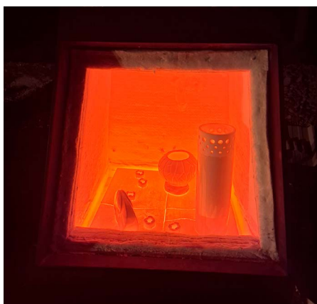
Pièce en fin de cuisson : 960 degrés
