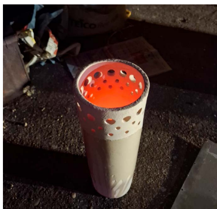
Pièce incandescente sortie du four pour provoquer un choc thermique
