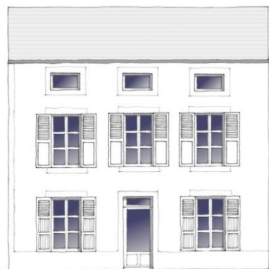
4 - Le bâti classique à 3 travées et plus : percements symétriques et axés
