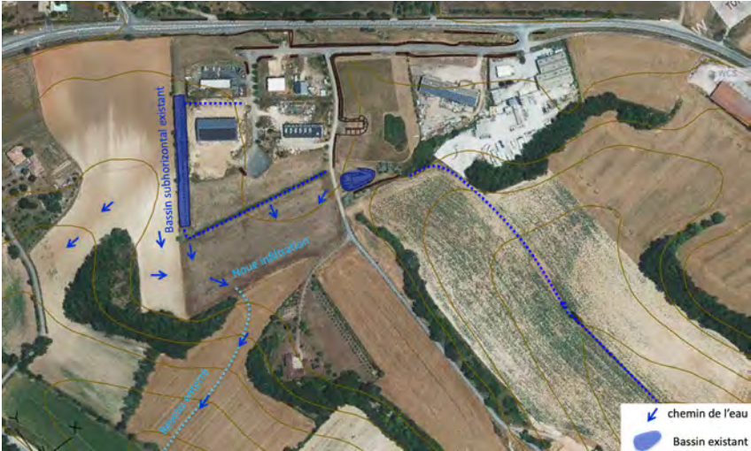
Gestion des eaux pluviales de l'extension de la ZAE
