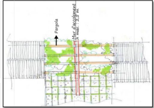
*Accolements des treilles par un mur enduit sur les 2 faces et avec une couverture plate en finition*
