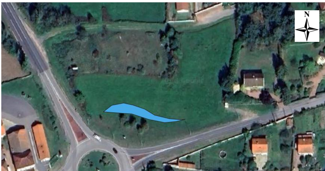
Figure 34 : Secteur plus humide du fait de la présence d'évacuation d'eau de pluie des axes routiers alentours
