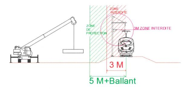
ZONE INTERDITE : Délimitée par un plan vertical situé à 3 m de l'axe de la voie.
