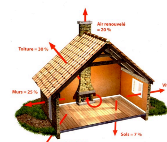
Evaluation des déperditions dans une maison non isolée
