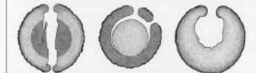
Fissure (ou gélivure) dans un chêne ; fissures (ou gélivures) associées à une rou lure dans un châtaignier ; fente dans un hêtre. Coupes transversales
