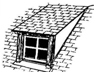
lucarne rampante ou en "chien couché"
