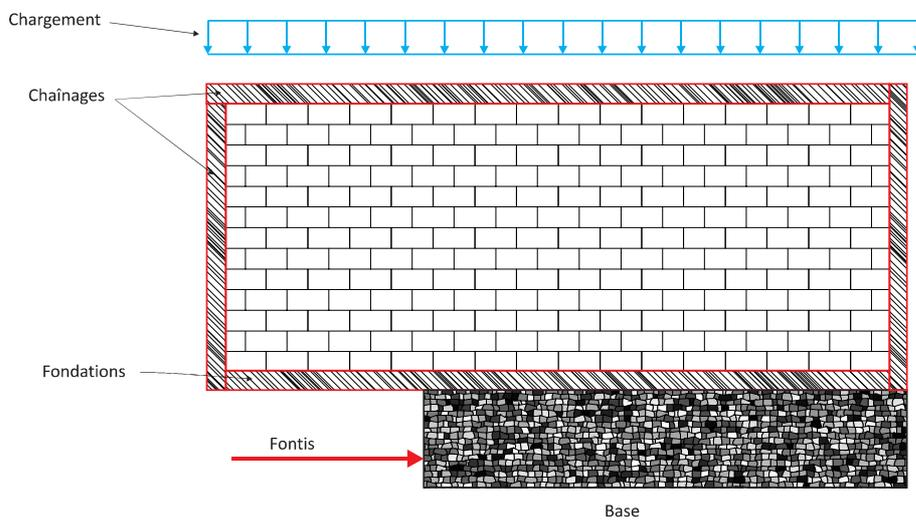
**Figure 3.6: Exemple de calcul d'un mur en maçonnerie**
