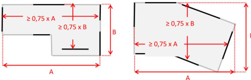
La configuration en plan doit être compacte. La plus grande dimension ne doit pas dépasser deux fois la plus petite dimension ( $0,5 \leq A/B \leq 2$ ).
