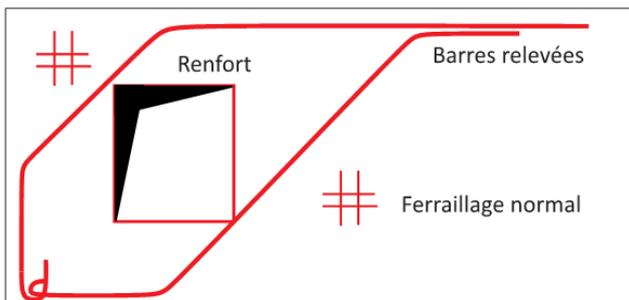
**Figure 3.10: Exemple d'un renfort d'une ouverture**
