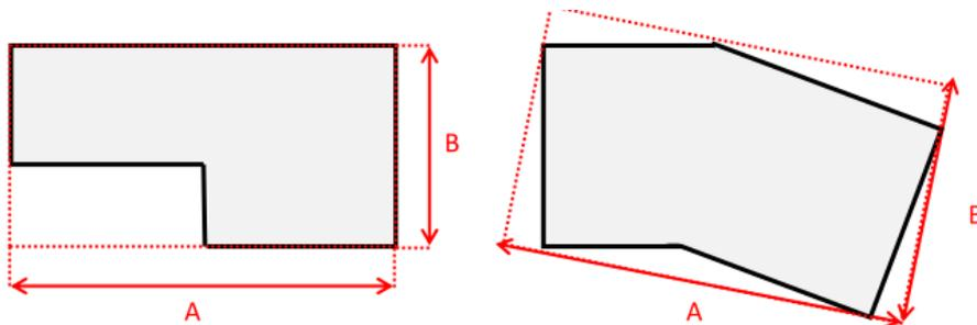
Les retraits par rapport au polygone convexe circonscrit au plancher ou à la charpente faisant office de diaphragme doivent respecter les conditions suivantes (pour chaque niveau) :
