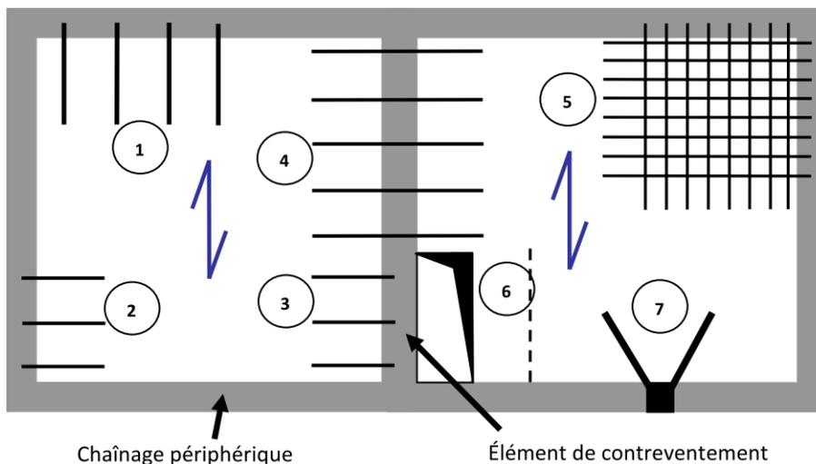
Dans les deux directions du plancher, toutes les armatures doivent être prolongées pour être ancrées dans les chaînages.
