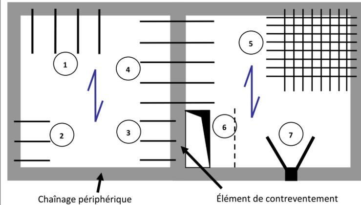
1. liaisons dans le sens porteur du plancher (armatures des éléments ou ajoutées)
