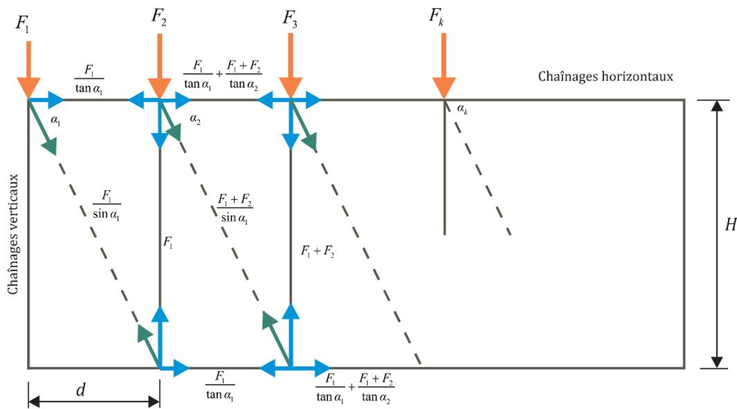
**Figure 5.1: Transmission des charges entre bielles et tirants**
