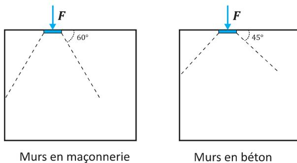
**Figure 3.7: Angles de transfert des charges verticales**
