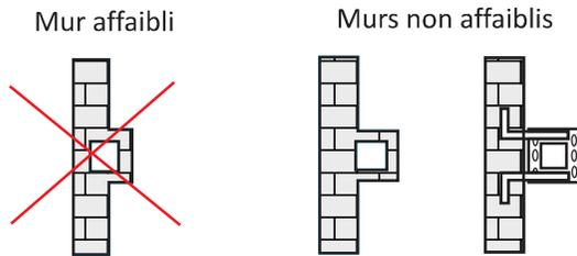
La mise en place de ceintures en plat en acier est recommandée.
