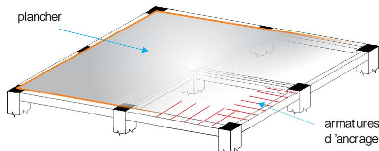
**Figure 3.13: Armatures d'ancrage aux bords des planchers**
