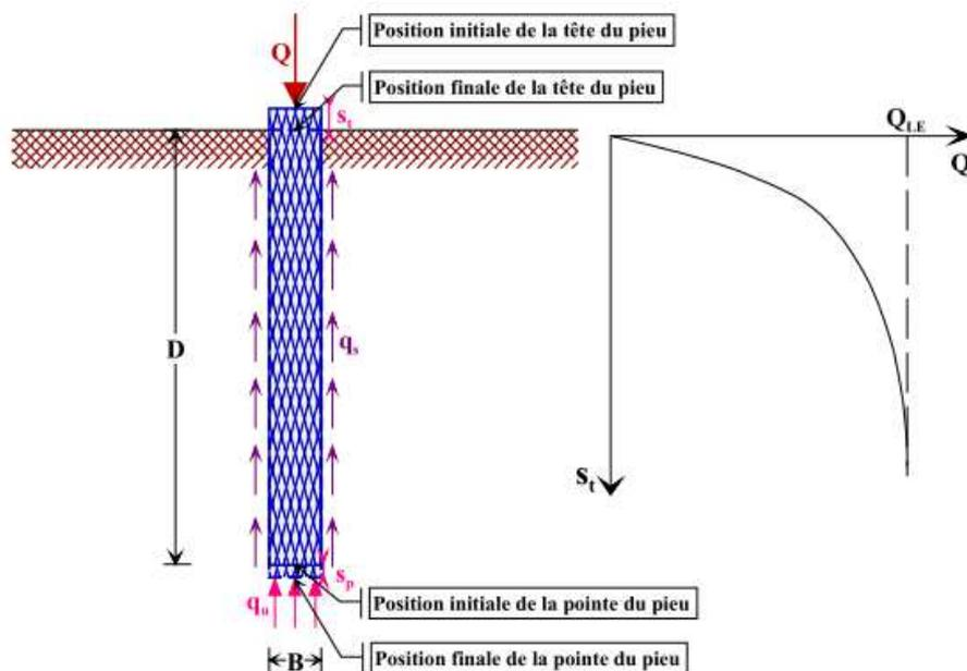
Figure 4.9: Principe de calcul la résistance d'un pieu
