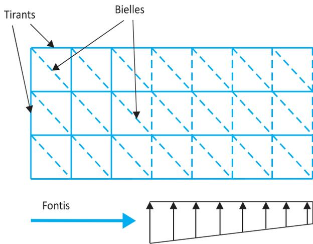
**Figure 3.8 : Exemple d'un schéma des bielles-tirants d'un mur**
