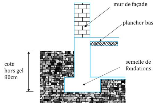
Les fondations doivent être dimensionnées au plus juste vis-à-vis de la contrainte de calcul du sol et doivent pouvoir reprendre la partie de charge engendrée par la perte d'appuis.
