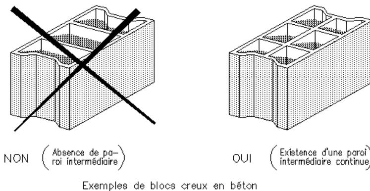
Les éléments de béton doivent répondre aux résistances minimales suivantes :
