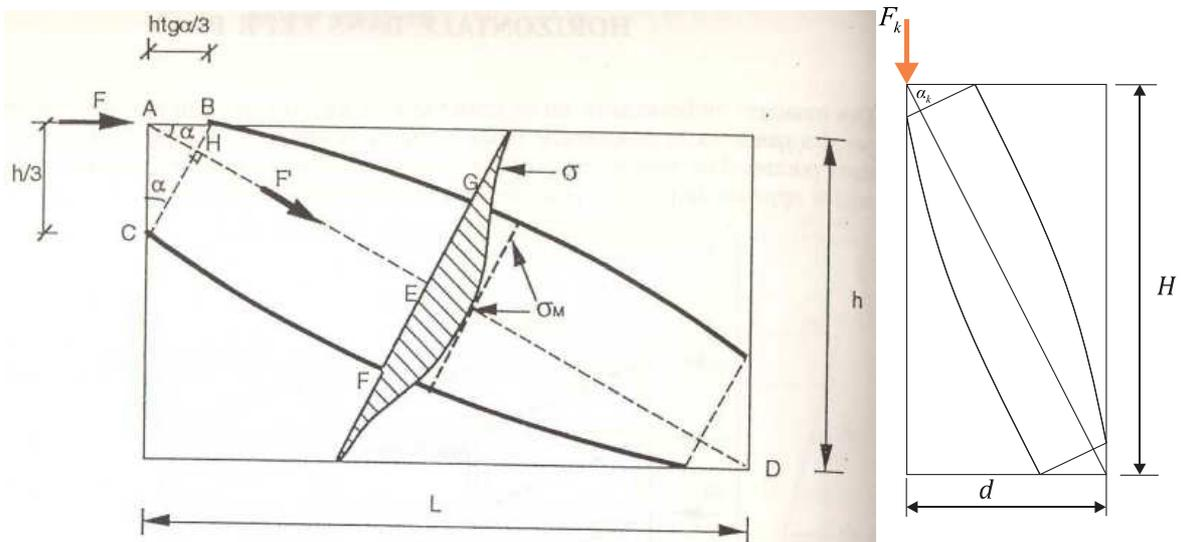
**Figure 5.2: Détermination de la largeur de la bielle (Henri Thonier, Tome 3)**
