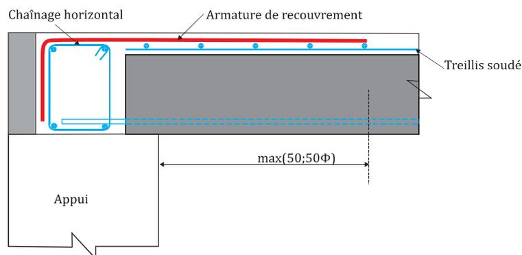
Figure 4.13: Dispositions des armatures de recouvrement du plancher
