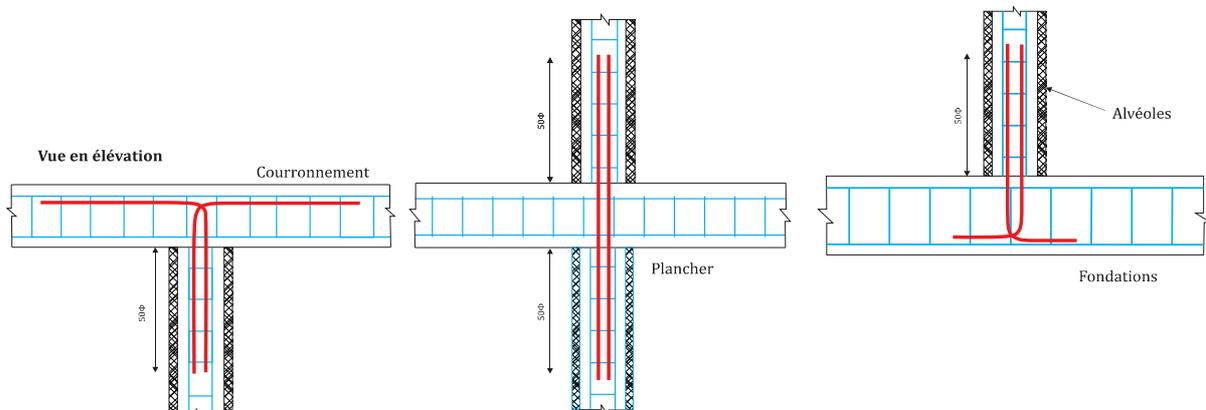
**Figure 4.6: Exemple de liaisons des chaînages verticaux**
